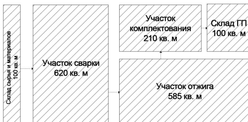
Рис. 4 Предлагаемое расположение производственных участков в новом цеху
